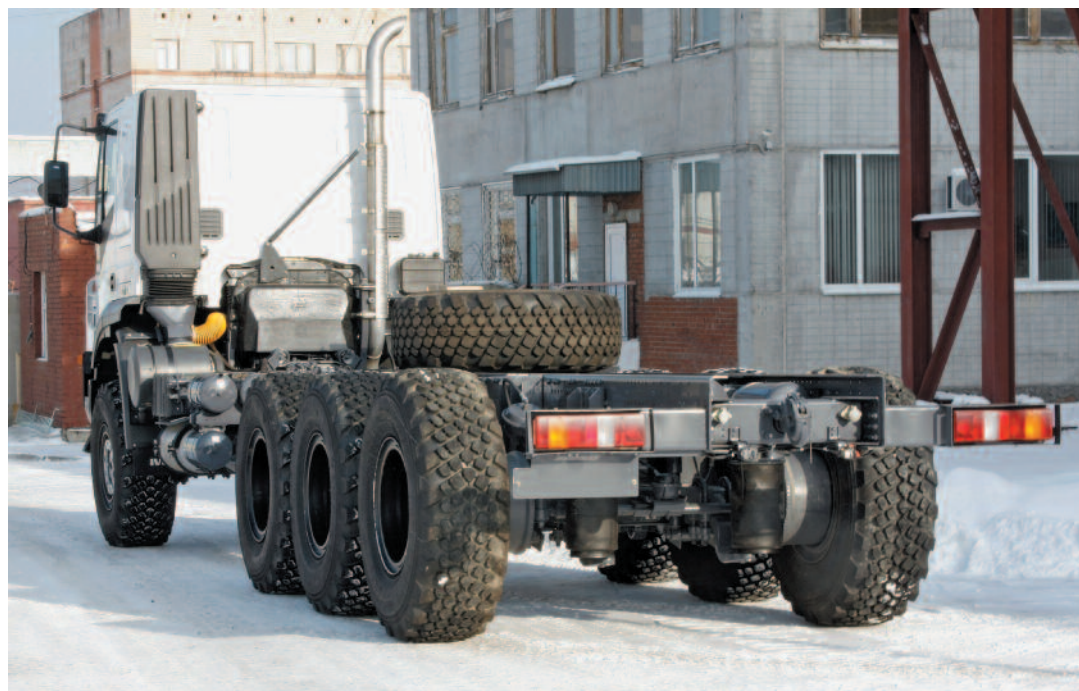
Представители модельного ряда СП – сортиментовоз с манипулятором (6х6) и шасси с монтажной длиной рамы 9,5 м (8х6)
