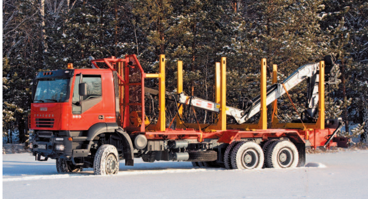
Представители модельного ряда СП – сортиментовоз с манипулятором (6х6) и шасси с монтажной длиной рамы 9,5 м (8х6)
