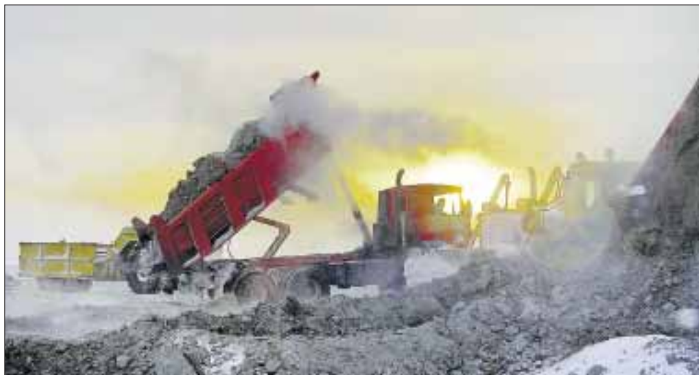
ДЕЛАЕМЫЕ В МИАССЕ САМОСВАЛЫ УСПЕШНО РАБОТАЮТ ДАЖЕ В СУРОВЫХ УСЛОВИЯХ СЕВЕРА. ИХ УСПЕХ ВО МНОГОМ ОБЕСПЕЧЕН СВЕРХЭФФЕКТИВНОЙ СИСТЕМОЙ ПОДОГРЕВА КУЗОВА
