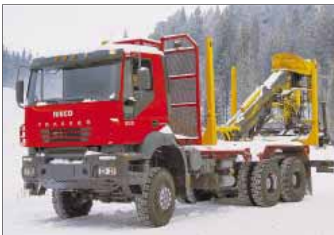
ТРЕХОСНЫЙ АВТОМОБИЛЬ IVECO ТРАККЕР С СОРТИМЕНТОВОЗНОЙ ПЛАТФОРМОЙ, КОТОРУЮ ЗАВОД САМОСТОЯТЕЛЬНО ОСНАЩАЕТ КРАНОМ-МАНИПУЛЯТОРОМ
