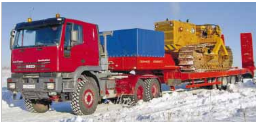
ВЫПУЩЕННЫЙ В МИАССЕ СЕДЕЛЬНЫЙ ТЯГАЧ IVECO TRAKKER ПРЕДЫДУЩЕГО ПОКОЛЕНИЯ С ПОЛУПРИЦЕПОМ ДЛЯ ПЕРЕВОЗКИ СТРОИТЕЛЬНОЙ ТЕХНИКИ
