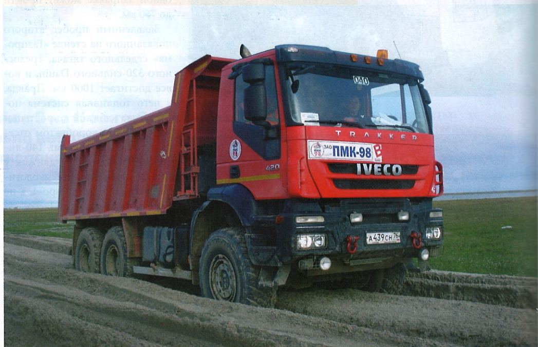
Одна из наиболее востребованных моделей «Ивеко-АМТ» – самосвал с колесной формулой 6х6, способный работать на любых технологических дорогах и в любых климатических условиях. Самосвальные платформы задней разгрузки предприятие изготавливает самостоятельно.
