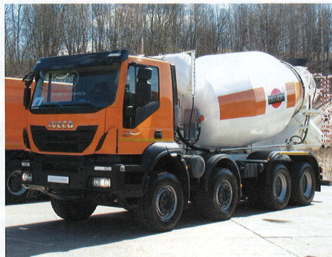
>>> Автобетономеситель Tigarbo на шасси Iveco Trakker 8x4
