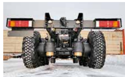
У четырехосников «ленивый» мост устанавливают на пневмоподвеске
