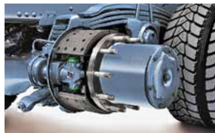
Тормозные механизмы у Trakker барабанные, с клиновым разжимом
