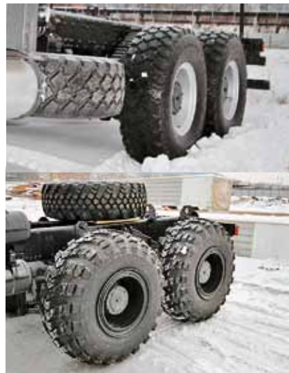
Однокатная ошиновка существенно улучшает проходимость на бездорожье
