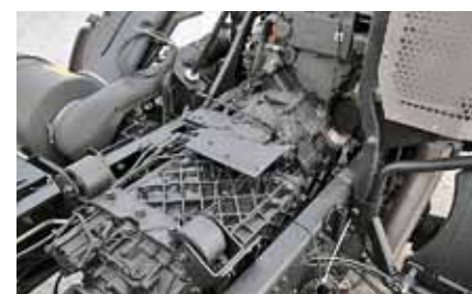
Коробки передач – немецкие 16-ступенчатые ZF 16S2220
