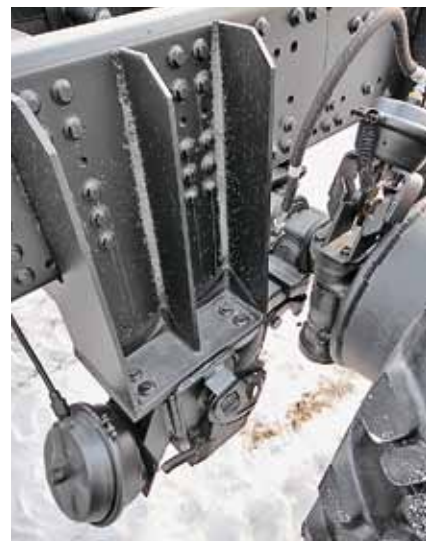
Так устроена подвеска «ленивой» оси IVECO Trakker 8x6
