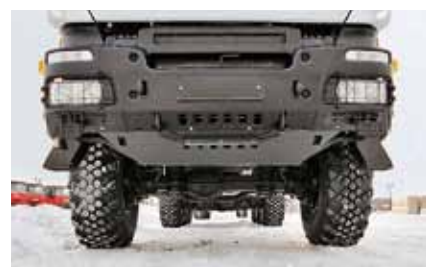
Стальной трехэлементный бампер дополнен мощным защитным листом
