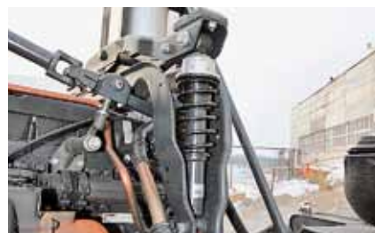
Подвеска кабины – на четырех пружинных стойках. Пневматика – у Stralis
