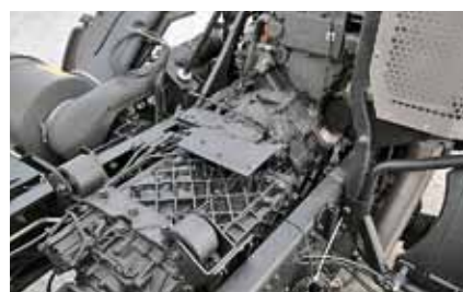
Коробки передач – немецкие 16-ступенчатые ZF 16S2220
