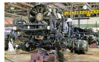
На небольшом конвейере рама постепенно обрастает агрегатами
