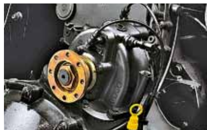
От ГРМ двигателя Cursorg тоже есть возможность отбора мощности
