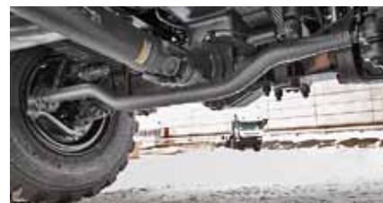
Ведущие мосты со ступичными редукторами – залог хорошего клиренса
