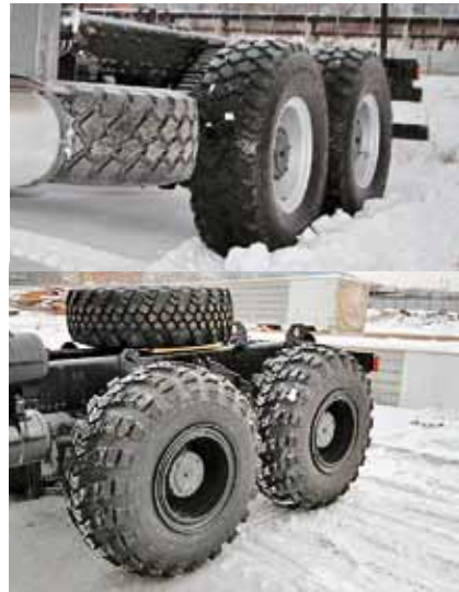
Однокатная ошиновка существенно улучшает проходимость на бездорожье
